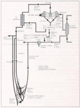
Bild 2. CO<sub>2</sub>-freie Wärme-Kraft-Kopplung: gleichzeitige Wärme- und Elektrizitätserzeugung mit einer HDR-Anlage (63 MW<sub>e</sub>, 153 MW<sub>th</sub>, Pumpleistung 19 MW<sub>e</sub>, nach Batchelor 1989)
