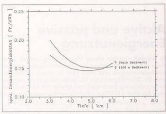
Bild 5. Berechnung der Gesamtenergiekosten einer HDR-Anlage bei variabler Tiefe für das Simplon-Gebiet (NEFF-Projekt Nr. 359)
