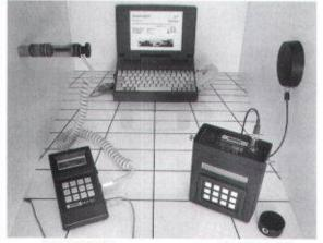
COLEBRAND KORROSION-DETECTOR COLEBRAND BETON DECUMETER
