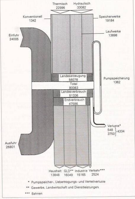
Bild 3. Flussdiagramm der Elektrizität 1991 (GWh)
