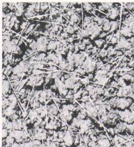
Bild 3. Die Stahlfaser als neue Spritzbetonbewehrung
