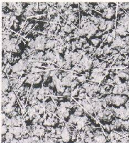
Bild 3. Die Stahlfaser als neue Spritzbetonbewehrung
