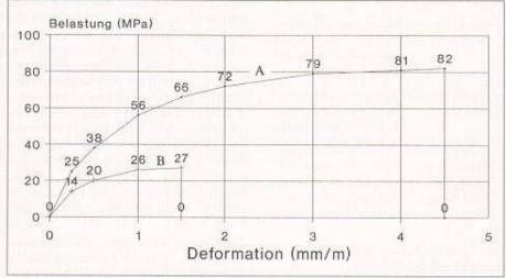
Bild 2. Vergleich des Energieadsorbtionsvermögens von Hartbeton mit metallischen Hartstoffen (A) im Vergleich zu einem guten Beton (B) anhand des Kraft-Stauchungs-Diagramms
