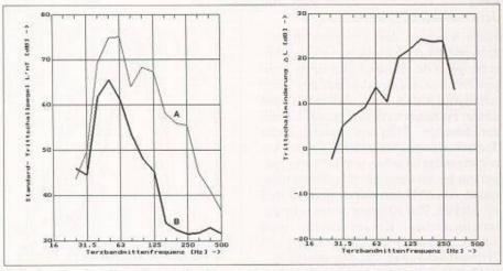
Unterlagsboden-Anordnung 5: Dämmaterial dreilagig aus 1x20 mm und 2x15 mm dicken Trittschalldämmplatten (Glaswolle)
