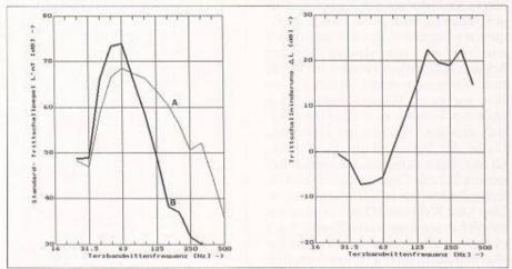
Unterlagsboden-Anordnung 3: Dämmaterial einlagig aus 1x20 mm dicken Trittschalldämmplatten (Glaswolle)
