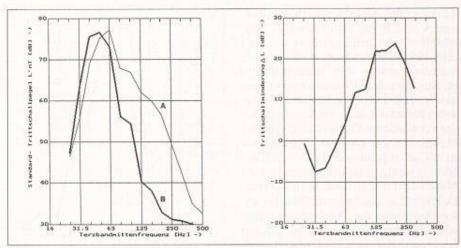
Unterlagsboden-Anordnung 1: Dämmaterial zweilagig aus 2x15 mm dicken Trittschalldämmplatten (Glaswolle)
