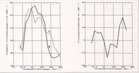
Unterlagsboden-Anordnung 6: Dämmaterial zweilagig aus 1x20 mm dicken Schaumkunststoffplatten (nicht elastifiziert) und 1x11 mm dicken Trittschalldämmplatten (elastifizierter Schaumkunststoff)
