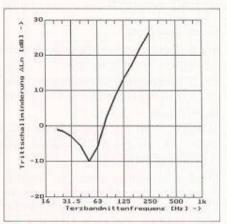
Darstellung der nach Beziehung (2) errechneten Trittschallminderung  $\triangle L_w$  des Unterlagsbodens (Der Verlustfaktor des Dämmaterials wurde zu d=0,10 angenommen)
