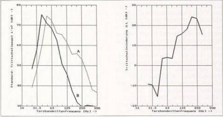
Unterlagsboden-Anordnung 2: Dämmaterial aus 2x22 mm dicken Trittschalldämmplatten (elastifizierter Schaumkunststoff)
