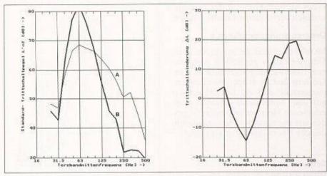
Unterlagsboden-Anordnung 4: Dämmaterial einlagig aus 1x22 mm dicken Trittschalldämmplatten (elastifizierter Schaumkunststoff)
