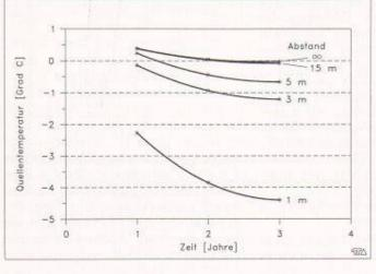
Bild 8. Die Abnahme der durchschnittlichen Quellentemperatur in Abhängigkeit vom Abstand zwischen zwei Erdwärmesonden, aus [5]
