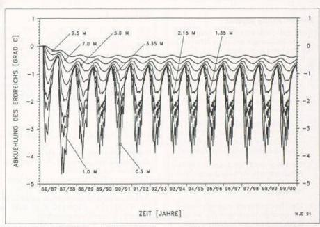
Bild 7. Die Abkühlung des Erdreichs im Umfeld der Erdwärmesonde in Elgg gegenüber dem Ruhezustand in verschiedenen radialen Distanzen über 14 modellierte Betriebsjahre, aus [3]
