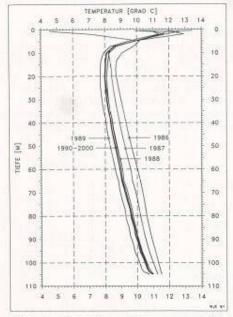
Bild 6. Modellierte Temperaturprofile der Anlage Elgg in 50 cm Abstand von der Erdwärmesonde. Dargestellt ist das Profil vom Dezember 1986 (modellierter Ruhezustand) sowie die Profile vom 30. September jedes simulierten Betriebsjahres, aus [3]
