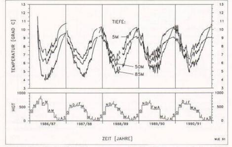
Bild 4. Der zeitliche Verlauf der gemessenen Erdreichtemperaturen in 5 m, 50 m und 85 m Tiefe und 50 cm Abstand von der Erdwärmesonde in Elgg über fünf Betriebsjahre (HGT: Heizgradtage 20/12), aus [3]
