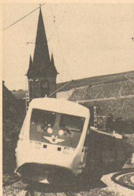
Dank der aktiven gleisbogenabhängigen Wagenkastensteuerung und Drehgestellen mit radial gesteuerten Achsen erreicht der Schnellzug X2000 von ABB auf bestehenden Trassen höhere Kurven- und Spitzengeschwindigkeiten, wodurch sich Reisezeiten um bis zu 30 Prozent verkürzen.
