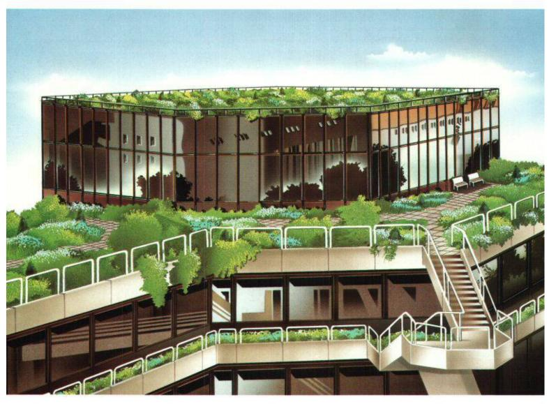
Styrodur ist der ideale Wärmedämmstoff für begrünte und bepflanzte Flachdächer. Das druckfeste Styrodur nimmt kaum Wasser auf, ist alterungsbeständig und bietet deshalb einen dauerhaften Wärmeschutz. Diese besonderen Eigenschaften ermöglichen das Umkehrdachverfahren (UK-Dach). Styrodur wird über der Dachabdichtung verlegt. So wird sie vor mechanischen Einwirkungen
