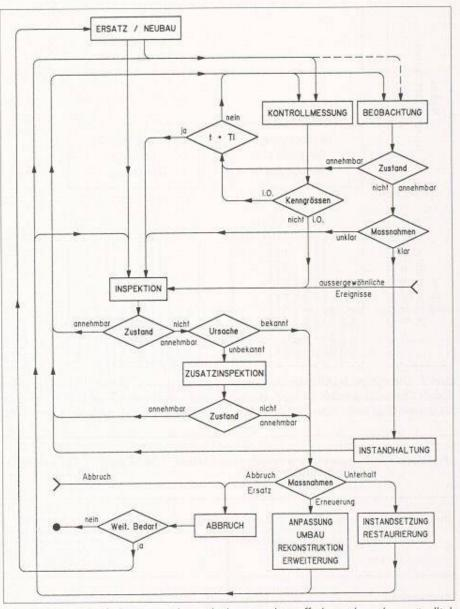
Bild 5. Das Ablaufschema, in das sich die Haupbegriffe logisch und verständlich einfügen müssen, zeigt die grundsätzlichen Planungs- und Bauprozesse als Flussdiagramm
