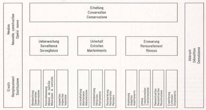
Bild 2. Die Hauptbegriffe der Bauwerkserhaltung müssen eindeutig sein, in andere Landessprachen mit gleicher Folgerichtigkeit übersetzt werden können, die wirklichen Zusammenhänge und nötigen Unterscheidungen zwangslos aufzeigen und so angeordnet sein, dass Beziehungen und Strukturen ohne weiteren Kommentar sichtbar werden
