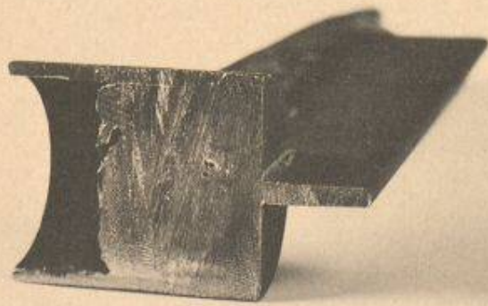
Schnitt durch die Cadwell-Schweissung. Band und Kabel sind molekular fest verbunden.
