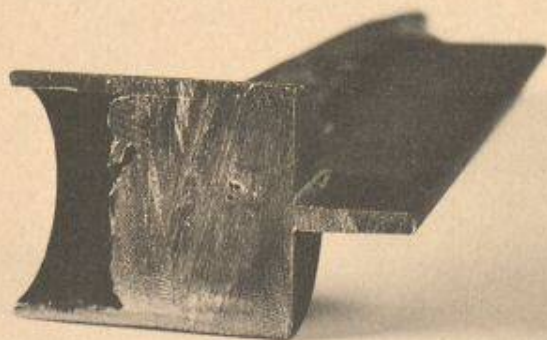
Schnitt durch die Cadweld-Schweissung. Band und Kabel sind molekular fest verbunden.
