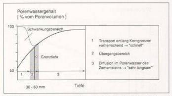
Bild 11. Porenwasserverteilung im Deckschichtbereich und Grenzeindringtiefen
