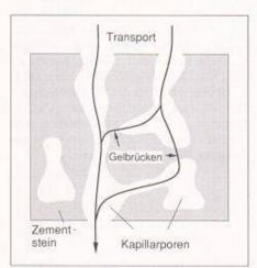
Bild 1. Transportmechanismus im Zementstein
