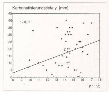
Bild 9. «Korrelation» zwischen Karbonatisierungstiefe und Kapillarporosität bei einem √I-Wachstumsgesetz
