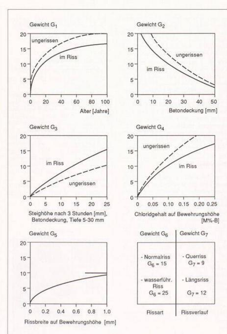
Bild 7. Die Korrosion beeinflussende Parameter und deren Gewichtung
