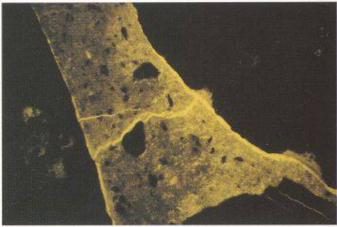
Bild 3. Körnerverbindender Mikroriss im Zementstein, Rissbreite ca. 20 µm
