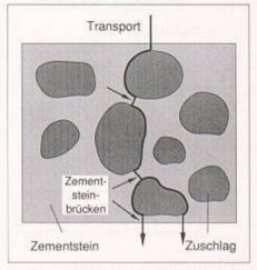
Bild 4. Transportmechanismus im Beton
