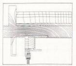
Bild 5. Flachdach mit auskragender Stahlbetondecke bei 20 °C Innen- und 4,5 °C Aussentemperatur
