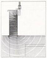
Bild 7. Sockel mit Fensteranschlag bei 20 °C Innen- und 4,5 °C Aussentemperatur
