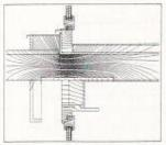
Bild 6. Durchbetonierter Balkon mit Fenstersturz und Balkontüre bei 20 °C Innenund 4,5 °C Aussentemperatur
