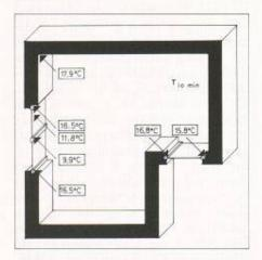
doch eine Kopplung von Wärmebrücken auf eine Verstärkung des Wärmeabflusses; die Entschärfung in diesem speziellen Beispiel ist somit nicht typisch (vgl. [1]).
