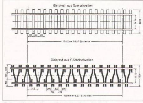
Gleise mit Querschwellen und Y-Stahlschwellen im Vergleich
