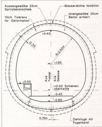
Bild 7. Tunnel-Normalprofil NATM-Tunnel
