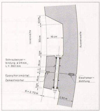
Bild 4. Detail Tübbing-Längsfuge
