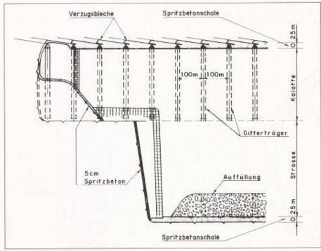
Bild 5. Vortriebsschema NATM, Längsschnitt
