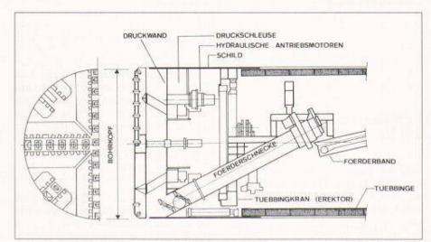
Bild 2. Modifizierter Erddruckschild mit Rollenmeisseln
