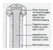
Perfekte SELKIRK Produkt-Konzeption: 3-schaliger Aufbau mit Innen- und Aussenschale aus hochwertigem Edelstahl, dazwischen der dicke Mineralwoll-Dämmstoff mit hoher
