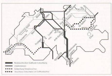
Streckenführung und Ausbau der Neuen Eisenbahn-Alpentransversale NEAT
