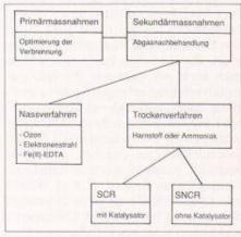
Bild 3. Möglichkeiten zur Stickoxidminderung in sauerstoffhaltigen Abgasen
