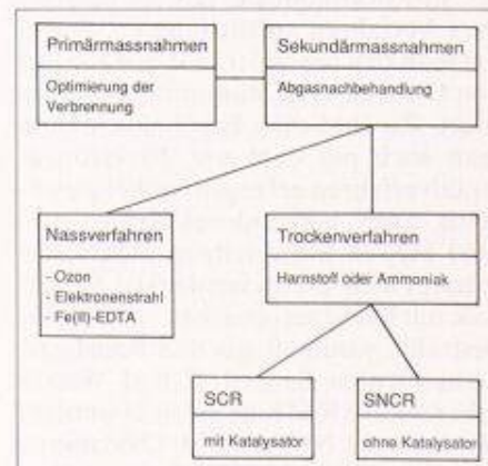
Bild 3. Möglichkeiten zur Stickoxidminderung in sauerstoffhaltigen Abgasen
