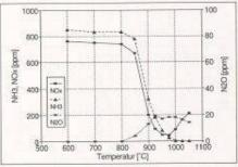
Bild 11. SNCR mit Ammoniak bei  $\alpha = 1.2, 10\% H_2O, 4\% O_2$
