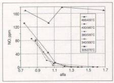
Bild 7. NO nach Katalysator. Parameter = Motor-Abgastemperatur/Katalysatortemperatur
