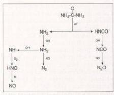
Bild 10. Vereinfachter Reaktionsmechanismus von SNCR mit Harnstoff
