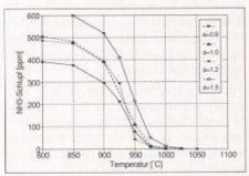
Bild 14. SNCR mit Harnstoff; NH<sub>3</sub>-Schlupf in Funktion der Temperatur und α als Parameter
