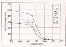
Bild 15. SNCR mit Harnstoff; HNCO-Schlupf in Funktion der Temperatur und α als Parameter
