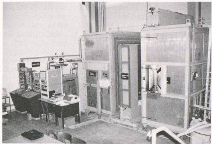
Bild 3. Ansicht der kalibrierten k-Wert-Kammer der EMPA. Die beiden Kammern sind leicht vom Prüfelementrahmen weggeschoben. Der Rahmen ist bereit für den Einbau eines neuen Prüfelementes. Die obere Abdeckung des Rahmens liegt auf der rechten Kammer. Links vorn das Steuer- und Messpult für den Betrieb während der Prüfung. Links hinten (verdeckt) die Kältemaschine
