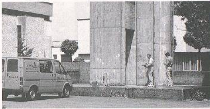
Messung der Eisenüberdeckung im Rahmen der Zustandsanalyse
