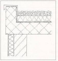
Bild 3. Randdetail Flachdach mit Wärmebrücke
