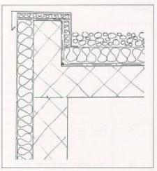
Bild 4. Randdetail «D2» gemäss Wärmebrückenkatalog 1, SIA-Documentation 99
