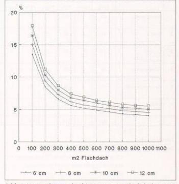
Bild 6. Verminderung des k-Wertes eines Flachdaches in % bei verschiedenen Isolationsdichten infolge einer Wärmebrücke im Randbereich in Abhängigkeit der Grundfläche in m<sup>2</sup>
