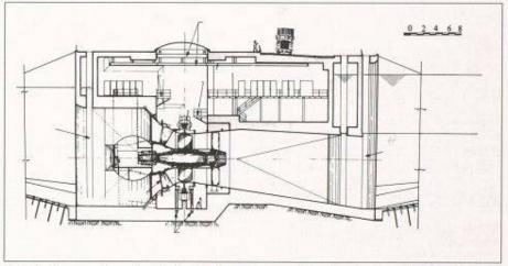
Bild 4. Längsschnitt durch die Strafloturbineneinheit des Gezeitenkraftwerkes Annapolis. Laufraddurchmesser 7,6 m (Zeichnung Sulzer-Escher Wyss)
