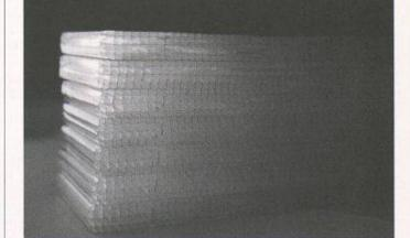
Bild 2. Transparente Isolation aus Polycarbonatwaben
