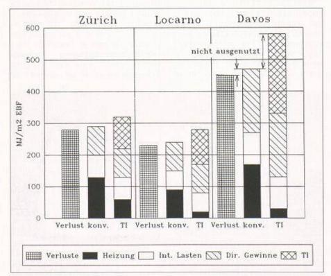
Bild 8. Energiebilanzen wie in Bild 7, jedoch für einen Wohnraum mit 25% Fensteranteil in der Südfassade und 32 cm dicke Backsteinwand. Die konventionelle Isolation ist 8 cm dick. Die Westwand ist eine fensterlose Aussenwand (32 cm Backstein und 8 cm Isolation). Die übrigen Wände, Boden und Decke grenzen an gleichartige Räume an
