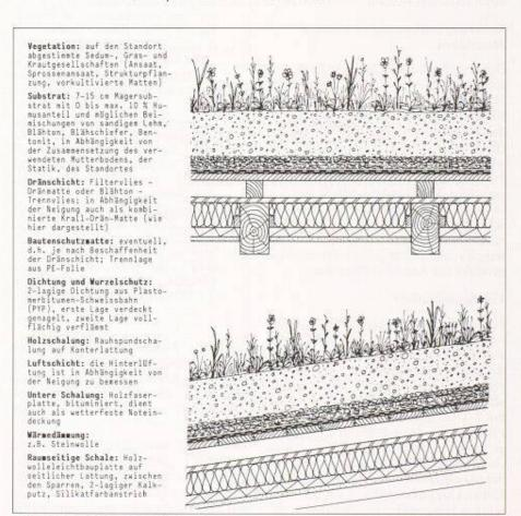
Bild 5. Durchlüftete Dachkonstruktion
