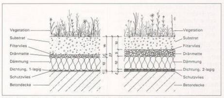
Bild 4. Umkehrdach, Beispiel des Gründachaufbaues in 2 Varianten
