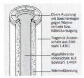
Perfekte SELKIRK Produkt-Konzeption: 3-schaliger Aufbau mit Innen- und Aussenschale aus hochwertigem Edelstahl, dazwischen der dicke Mineralwoll-Dämmstoff mit hoher Stoofdichte.
