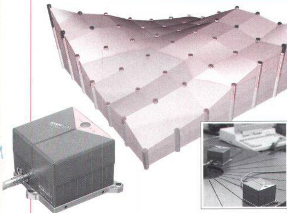
KERN NIVEL 20 ist ein hochpräzises Neigungsmesssystem für industrielle Applikationen, mit dem Sie gleichzeitig in 2 Achsen Neigungswerte und -richtungen mit hoher Auflösung (0,001 mm/m) erfassen können. Dadurch gewinnen Sie, z.B. bei der Aufnahme von Oberflächen-Profilen, erheblich Zeit, weil Aufstellungen nur in einer Richtung nötig sind. Damit erhöhen Sie gleichzeitig die Messgenauigkeit.
