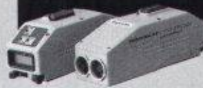
WILD DI1001, 5 mm + 5 ppm Für den Nahbereich bis 1,3 km
