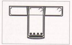
Bild 1. Plattenbalken verstärkt mit Faserverbundwerkstoffen
