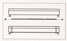
Bild 3. Herstellung eines vorgespannten Trägers, Krafteinleitungsbereiche verstärkt mit Faserverbundwerkstoffen
