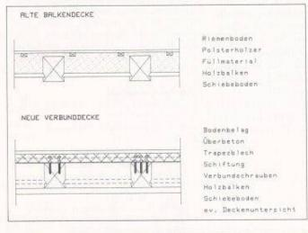
Bild 1. Deckenquerschnitte in Altbauten
