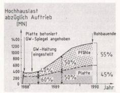
Bild 17. Gründung des Messeturms in Frankfurt. a) Querschnitt; b) Lastverteilung Pfähle und Platte
