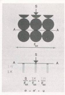
Bild 5. Das Prinzip der effektiven Spannungen
