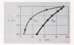
Bild 16. Setzungsmessungen unter dem Hochhaus AFE, Frankfurt. a) Setzungen; b) Setzungsverteilung,  $S_M$  = Messwert,  $S_R$  = Rechenwert
