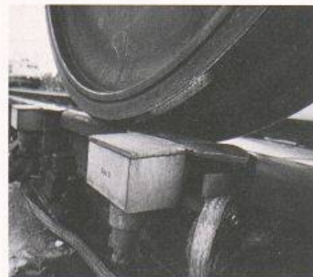
Die Auropa-Prüfanlage sitzt da, wo der Materialverschleiss am grössten ist: am Kontaktpunkt Rad/Schiene (Bild: Fraunhofer Gesellschaft)
