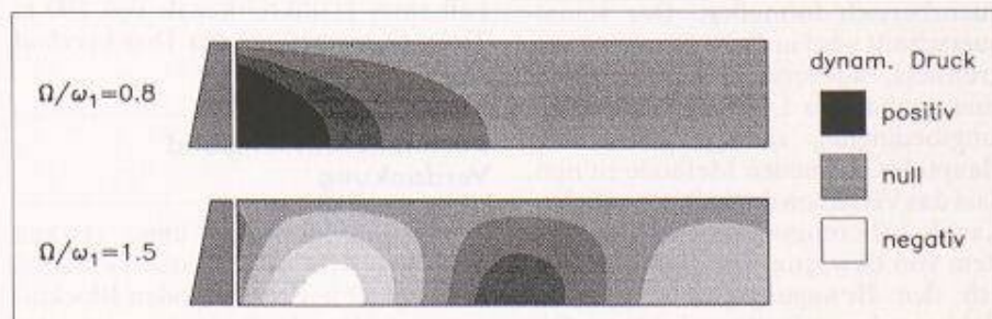
Bild 5. Dynamischer Druck bei verschiedenen Frequenzverhältnissen.
