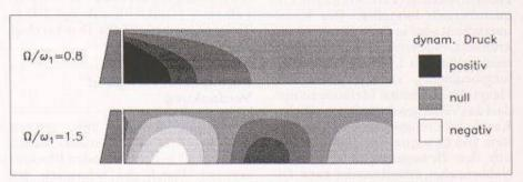
Bild 5. Dynamischer Druck bei verschiedenen Frequenzverhältnissen.
