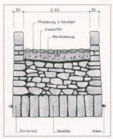
Bild 9. Planquerschnitt für die Rekonstruktion der Häderlisbrücke
