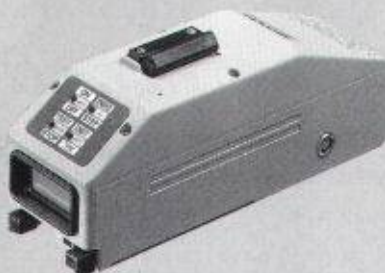
WILD DI2002 1 mm + 1 ppm Präzision für nahe und mittlere Bereiche
