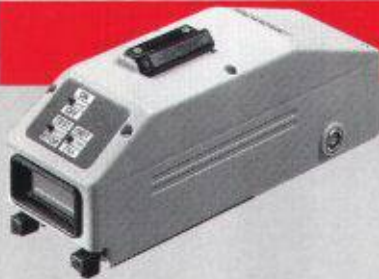
WILD DI1001 5 mm + 5 ppm Für den Nahbereich bis 1,3 km
