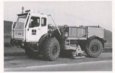
Einer der drei in der Nordostschweiz eingesetzten Vibratoren. Die geländegängigen Fahrzeuge haben ein Gewicht von je 16 t. In der Arbeitsstellung lasten davon max. 75% auf einer hydraulisch absenkbaren Grundplatte, die elektronisch gesteuert genau definierte Schwingungen erzeugt im Frequenzbereich zwischen 8 und 120 Hertz. Das Signal («Sweep») dauert 12 Sekunden. (Bild Nagra)
