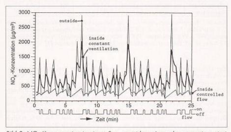
Bild 3.  $NO_{\chi}$ -Konzentration in einem Bus: «outside»= Aussenkonzentration; «inside constant ventilation»= Innenkonzentration bei konstanter Lüftungsrate; «inside controlled flow»= Innenkonzentration bei geregelter Lüftung und gleicher durchschnittlicher Flussrate
