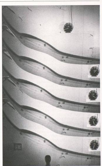
Bild 7. Serie von Schnappschüssen einer Granulatlawine vom Start bis zum Stillstand in einer Schussrinne mit konkav sowie konvex gekrümmten Segmenten des Bodens mit zugehöriger Zeitangabe (1 s = 1 Umdrehung des Zeigers)
