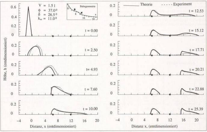
Bild 9:«Schnappschüsse» der Höhenverteilung einer Granulatlawine von 1,5 l Quarzsand vom Bewegungsbeginn (t=0) bis zum Stillstand (t=25,39) für die Bewegung entlang einer konkav-konvex gekrümmten Bahn. Die Symbole ◊ markieren den Übergang von konkaver zu konvexer Krümmung und umgekehrt; theoretische Resultate sind ausgezogen, experimentelle Resultate punktiert
