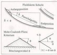
Bild 5. Zur Definition des Pauschalgefälles (oben), des Böschungswinkels, Φ (unten links) und der Coulombschen Fliessbedingung eines kohäsionslosen Materials (unten rechts), σ bezeichnet den Normaldruck, τ die Schubspannung
