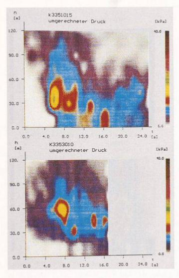
12. Zeit-Bild schnitte des auf natürliche Dimensionen umgerech-Staudruckes in Position A (oben) und B (unten). Die dazu verwendeten Daten entstammen dem Bild 11. Farbkodie-Die rung kann dem Balken rechts entnommen werden
