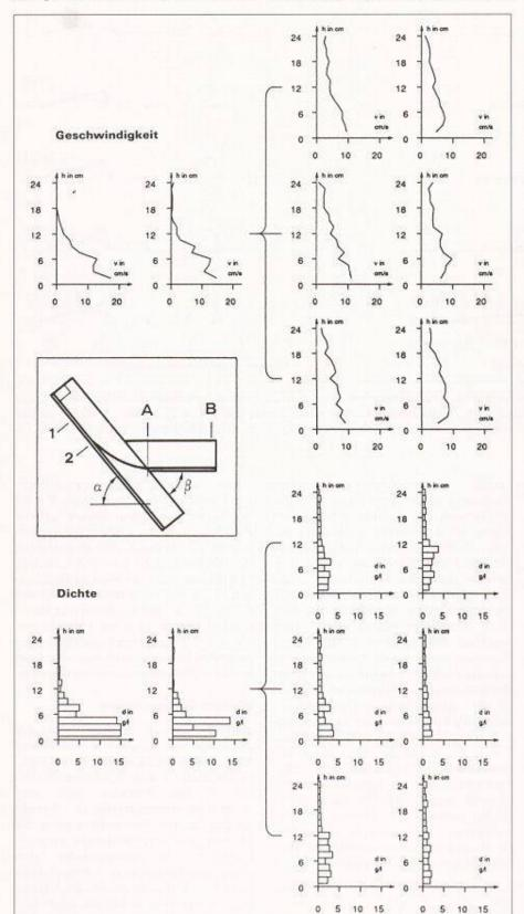
Bild 10. Geschwindigkeits- (oben) und Dichteprofile (unten) im Lawinenkörper einer Suspensionsströmung von Plastikpartikeln in einer in ruhendes Wasser eingetauchten Schussrinne. Links sind die Profile der Querschnitte 1 und 2, rechts jene von A und B dargestellt. α bezeichnet den Neigungswinkel (hier 35°), β den Knickwinkel (hier 3 Fälle, von oben nach unten, 30°, 45°, 55°), (aus [6])
