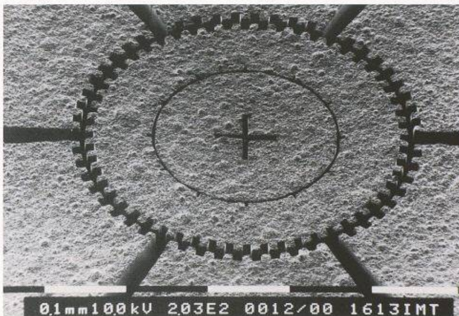
Rasterelektronenmikroskopische Aufnahme des Schrittmotors. Der Läufer des Schrittmotors ist von 6 Statorelementen umgeben, wobei die Rotation des Läufers durch das elektrische Wechselfeld zwischen den Zahnkränzen von Läufer und Statorelementen erzeugt wird. Die Drehfrequenz des Läufers ist variierbar vom Einzelschrittbetrieb bis 3400 Umdrehungen pro Minute
