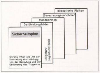
Bild 4. Schematische Darstellung des Inhalts eines Sicherheitsplans
