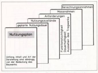
Bild 3. Schematische Darstellung des Inhalts eines Nutzungsplans
