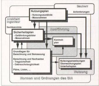
Bild 2. Schematische Darstellung der hierarchischen Folge von Ordnungsmitteln
