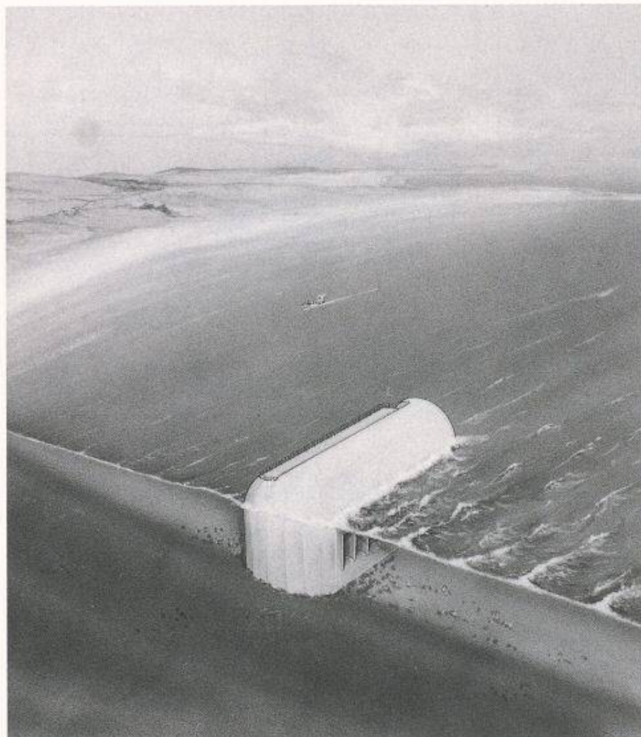
Bild 7. Oszillierende Wassersäule von NEL. «Artist's View» eines Moduls mit 4 Turbineneinheiten in rund 20 m tiefem Wasser. Maximale elektrische Leistung 1700 kW
