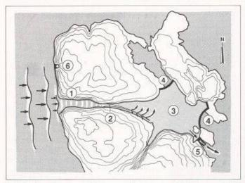
Bild 5. Tapchan von Norwave. Situation mit (1) Fassung, (2) «Tapered Channel», (3) Ausgleichsbecken, (4) Abschlusssperren, (5) Wasserkraftwerk, (6) Oszillierende Wassersäule von Kvaerner gemäss Bildern 2 und 3
