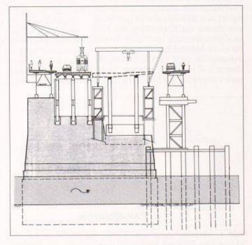
Bild 3. Verkehrs- und Umbauphase 4: Erstellen der neuen Brückenhälfte
