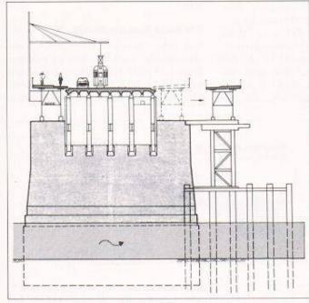
Bild 2. Verkehrs- und Umbauphase 3 der unterwasserseitigen Brückenhälfte: Ausschieben der bereits erstellten neuen Seitenbrücke auf die Hilfsbrücke
