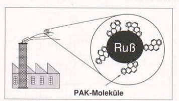
Bild 1. Verbrennungsprozesse aller Art emittieren entsprechend ihrer Effizienz mehr oder weniger viele Russteilchen, welche mit polyzyklischen aromatischen Kohlenwasserstoffen (PAK) beschichtet sind, in die Atmosphäre
