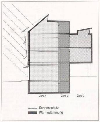
Bild 5. Wärmedämmung, Sonnenschutz, Beleuchtung und entsprechende Zonierung
