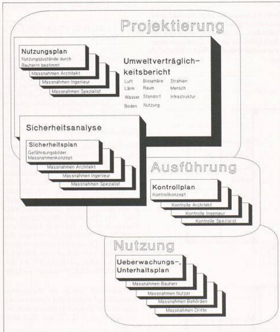
Bild 2. Zusammenhänge zwischen Nutzungs- und Sicherheitsplan mit Umwelt- und Sicherheitsabklärungen
