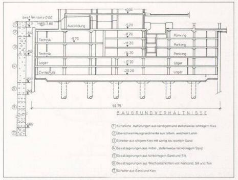
Bild 2. Längsschnitt durch die Baugrube
