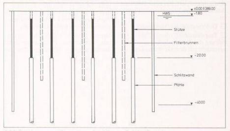
Bild 4. Schema von Baugrubenabschluss und Pfahlfundation
