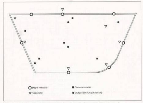
Bild 5. Instrumentarium zur Baugrubenüberwachung im Bauzustand
