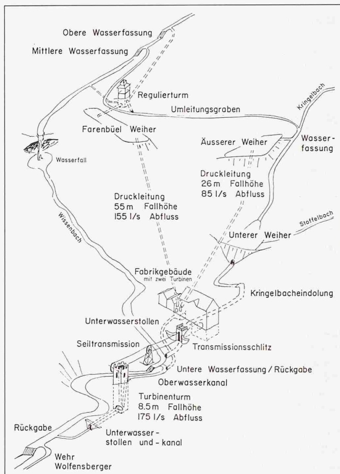
Bild 10. Schematische Perspektive des Wasserkraftsystems Neuthal entsprechend dem Konzessionsgesuch aus dem Jahre 1878. Der Kern der drei eigenständigen, aber eng ineinander verflochtenen Anlagen bestand aus Seiltransmission und zwei Turbinen im Fabrikgebäude, gespeist mit Druckleitungen vom Äusseren Weiher bzw. vom Farenbuelweiher.
