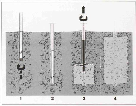
Bild 1. Schematischer Ablauf des 1-Phasen-Jet-Grouting
