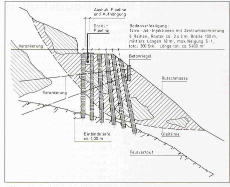
Bild 6. Hangsicherung an der Via Mala-Strasse: Projekt
