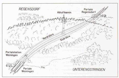
Bild 1. Der Gubristtunnel, schematische Darstellung, Nordröhre 3267 m, Südröhre 3250 m (verändert nach [2])
