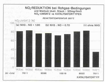
Bild 9. Entstickung von Rauchgas aus der KVA Müllheim unter Rohgas-Bedingungen: NO<sub>x</sub>-Umsatz von verschiedenen Katalysatortypen, ermittelt aus Halbstundenmittelwerten
