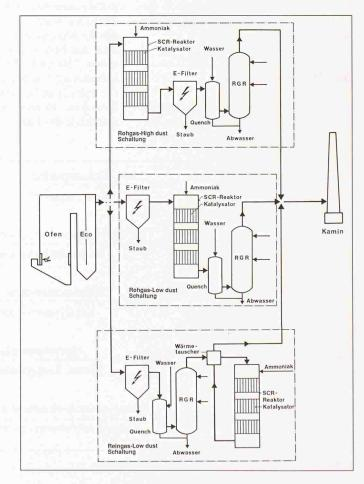
Bild 3. Übersicht der Schaltungsvarianten zum SCR-Verfahren in Kehrichtverbrennungsanlagen
