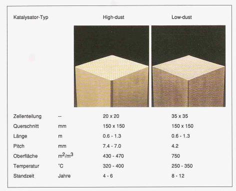
Bild 4. SCR-Katalysatoren aus Titandioxid ( $TiO_2$ ) mit den aktiven Metalloxiden Vanadiumpentoxid ( $V_2O_5$ ) und Wolframtrioxid ( $WO_3$ ): Vergleich der technischen Daten
