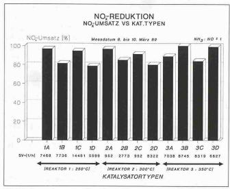
Bild 7. Entstickung von Rauchgas der KVA
