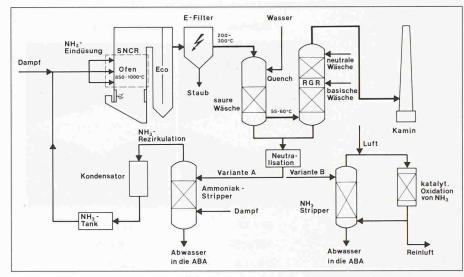
Bild 2. Schema zum SNCR-Verfahren mit Variante A: Ammoniak-Rezirkulation und Variante B: Ammoniak-Entsorgung durch Strippen und katalytische Oxidation
