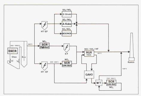
Bild 1. Technologische Möglichkeiten zur NO<sub>x</sub>-Reduzierung aus KVA-Abgasen: SNCR Selektive nicht-katalytische Reduk-tion, SCR Selektive katalytische Reduktion, Eco Economiser, HT-EF Hochtemperatur-Elektrofilter, WT Wärmetauscher, EF Elektrofilter, GAVO Gasvorwärmer, RGR Rauchgas-Reinigungsanlage
