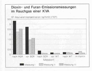
Bild 12. Reduktion der Dioxin- und Furanverbindungen nach dem SCR-Katalysator in einer KVA
