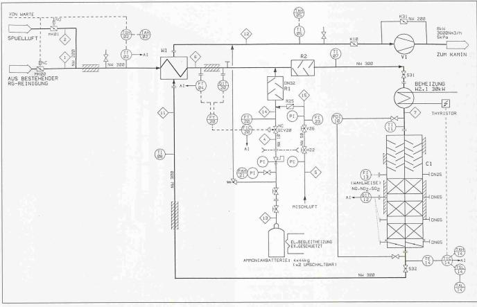
Bild 6. Verfahrensfliessbild der DeNO<sub>x</sub>-Pilotversuchsanlage mit Mess-, Steuer- und Regelungstechnik
