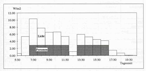
Bild 7. Typischer Tagesgang der internen Lasten für das Lagergebäude der Firma Amidro während der Sommerperiode
