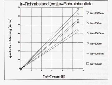
Bild 5. Stationäre Kennlinie der Kühldecke
