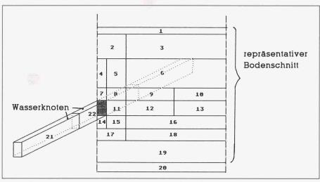
Bild 7. Modellierung eines repräsentativen Deckenschnittes
