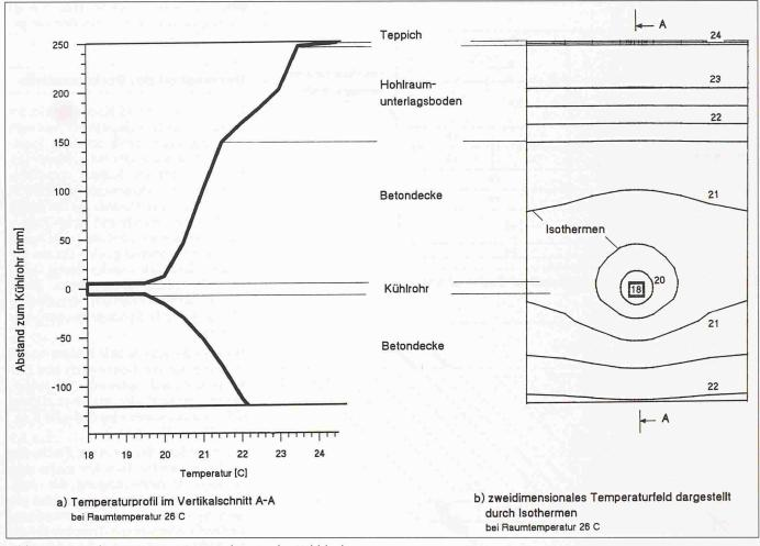
Bild 6. Beispiel einer Temperaturverteilung in der Kühldecke
