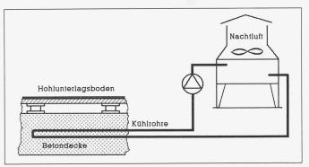
Bild 3. Kopplung der gekühlten Masse (Decke) mit dem Rückkühler im Nachtbetrieb
