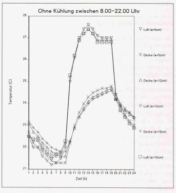
Bild 10. Einfluss der Einbautiefe der Rohre auf das dynamische Verhalten der Raumlufttemperatur
