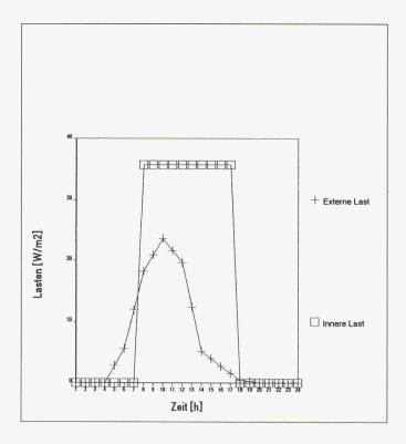
Bild 9. Zeitlicher Verlauf der inneren und externen Lasten
