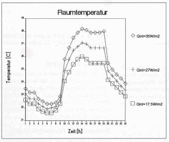
Bild 11. Einfluss der Grösse der inneren Last
